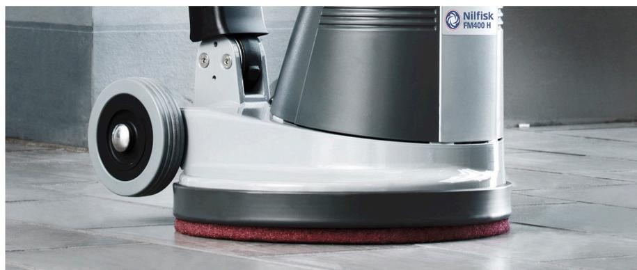
Les larges roues permettent de transporter les machines sans effort et de franchir les obstacles tels que les seuils de portes, les marches etc.
